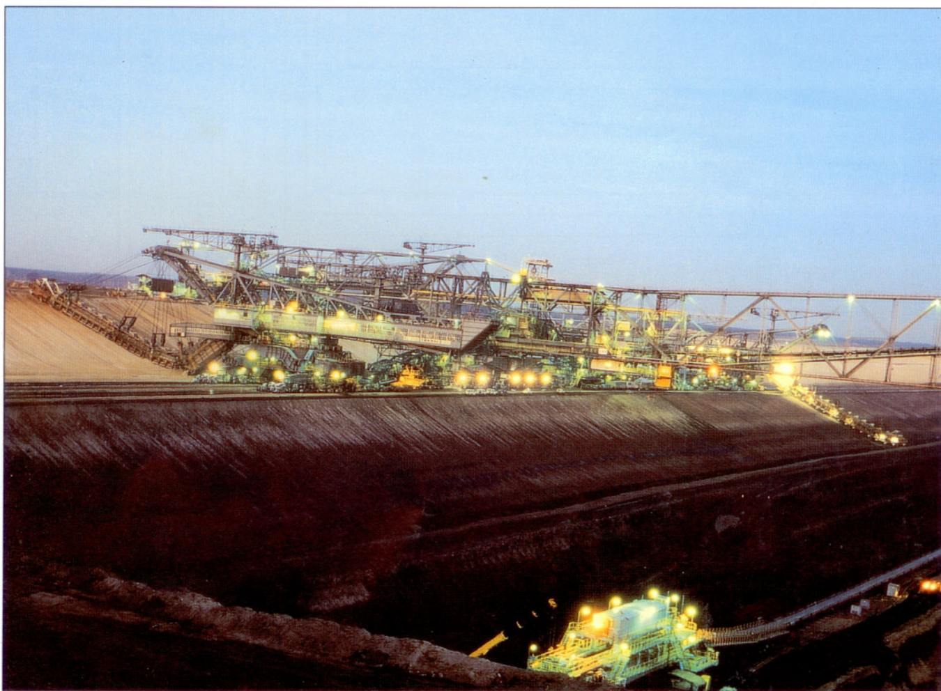
LAUBAG Tagebau Welzow-Süd, (povrchové doly) mostový komplex-skrývkový těžní most F 60 a tři korečková rypadla Es 3150 vybavené 582 přístroji ELHY
